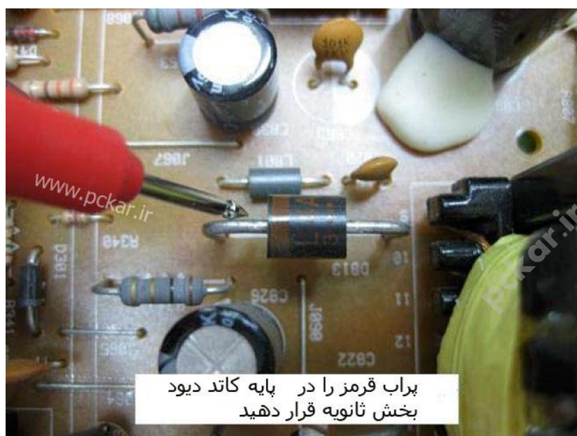
شکل ۱۱.۹ - نحوه صحیح قرار دادن پراب قرمز برای بررسی ولتاژهای مثبت SMPS
